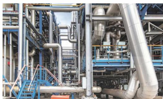
Установка гидрокрекинга вакуумного газоилья с секцией производства водорода
