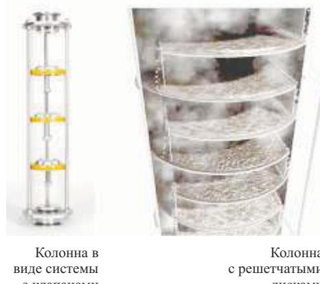
**Насадочная колонна** представляет собой цилиндрический вертикальный аппарат, заполненный по всей высоте или на отдельных участках насадкой определенных размеров и конфигурации.
