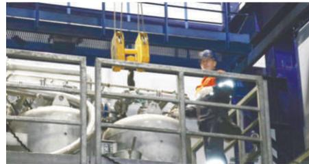
Оператор азотной станции №2 Владимир Тарасов проводит ревизию клапанной сборки линии №6 генератора азота АГ-1
