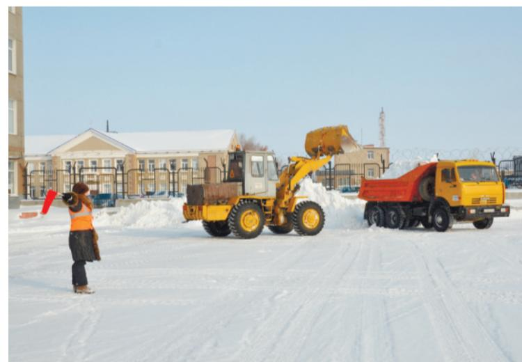
В соответствии с правилами безопасности снегоуборочная техника в обязательном порядке оборудуется проблесковыми маячками. Ответственное лицо в сигнальном жилете координирует процесс уборки снега с помощью сигнального флажка.
