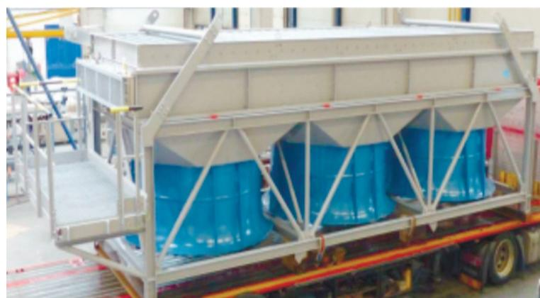
*Крупные производственные предприятия различных отраслей промышленности, расположенные вдали от природных источников воды, нуждаются в охлаждении технологических жидкостей, паров и газов. Для этих целей применяются специальные теплообменные установки – аппараты воздушного охлаждения (АВО).*
