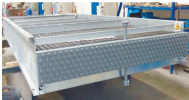
Аппараты воздушного охлаждения производства компании Benvig Heat Transfer
