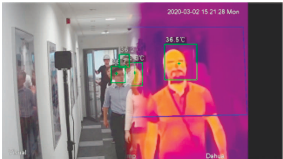
Тепловизоры позволяют выявить человека с повышенной температурой в плотном потоке людей
