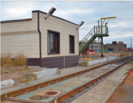
Железнодорожные весы «Рекон-150» производят измерения движущихся вагонов
