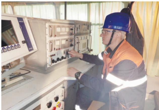
Электромонтер А.В.Свалов определяет место повреждения кабеля
