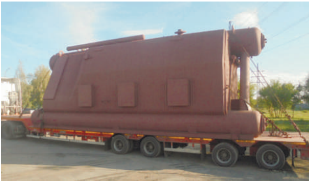
Паровой котел Р-1 доставили на Орский НПЗ на трале – специализированном прицепе с низкой посадкой
