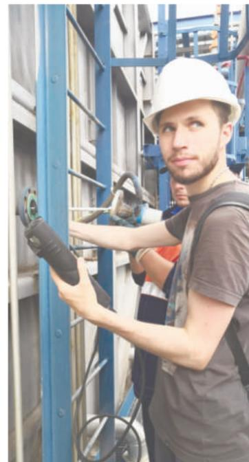
Специалист компании ООО «ГЦЭ-Энерго» проводит измерения параметров уходящих газов на технологической печи
