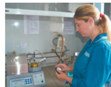
Лаборант Е.Ю.Феофанова осваивает аппарат для определения температуры вспышки в открытом тигле
