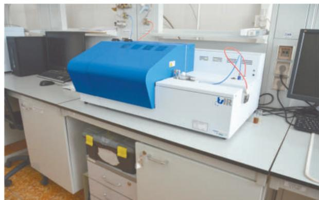
Автоматический анализатор с хемиллюминесцентным детектором, с помощью которого определяется содержание азота в продуктах
