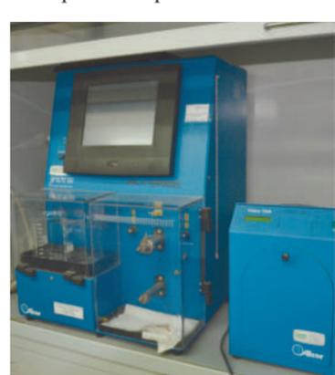
Анализатор термоокислительной стабильности топлив JFTOT
