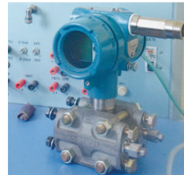
Метран-150 – один из самых распространенных датчиков давления, используемых на Орском НПЗ
