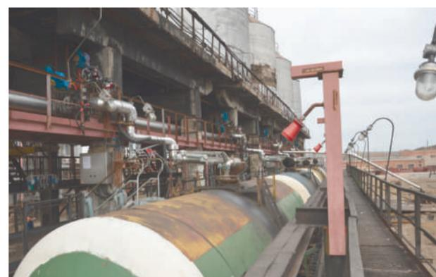
Новые устройства налива на эстакаде битумной установки 19-6М
