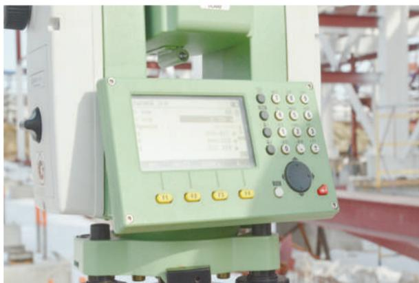
Универсальный геодезический прибор – тахеометр
