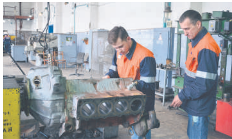
Студент 4 курса Орского технического техникума им.А.И.Стеценко Николай Прокопенко во время преддипломной практики проводит ремонт двигателей внутреннего сгорания под руководством мастера по ремонту АТЦ К.С.Салтыкова
