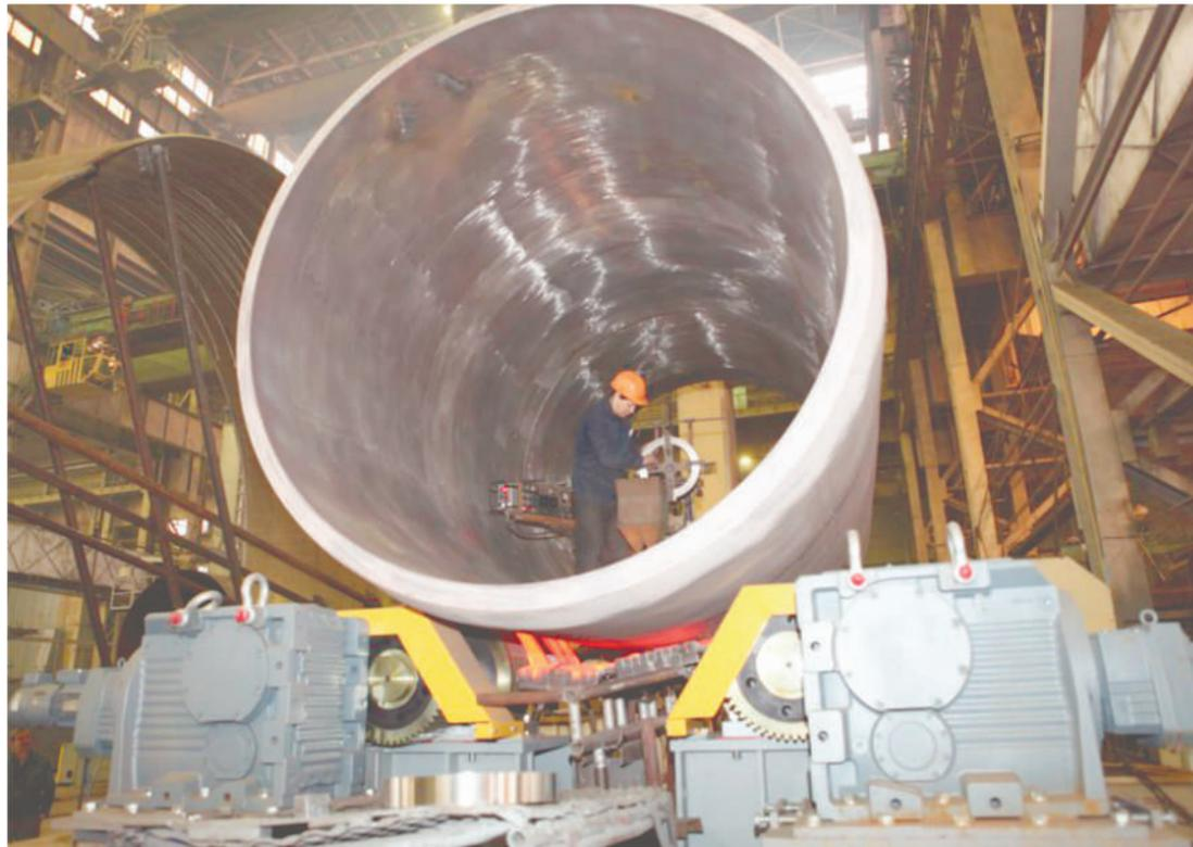
ОАО «Волгограднефтемаш» изготовит и поставит для строящейся установки гидрокрекинга Орского НПЗ два сепаратора высокого давления. Диаметр первого – горячего – составляет 3000 мм, толщина стенки – 153 мм, а вес – 134 тонны, второго – холодного – 2800 мм с толщиной стенки 148 мм и массой 154 тонны. Оба аппарата будут изготовлены в соответствии с требованиями международного стандарта ASME
