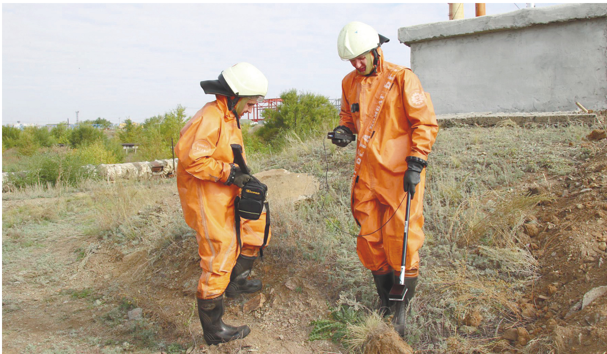
Члены НАСФ определяют показатели загазованности атмосферного воздуха
